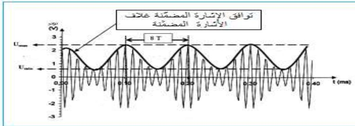
$$T = \frac{0,1 ms}{8} \quad \text{أي: } 8T = 0,1 ms \quad \text{2.2.2- دور التوتر المضمّن:}$$
